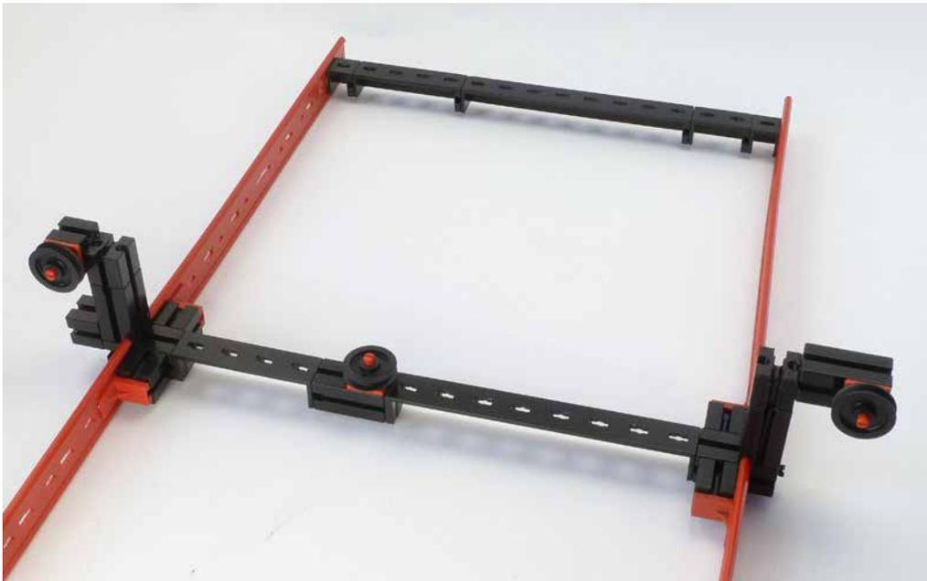
Abb. 21-15: Anbau der Seilführungseinheiten
